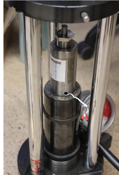
Figure 4: (a) A nyomásközvetítő közegként használt Daphne 7373 típusú kerozinban végbemenő nyomáscsökkenés a cella hűtése során. A nyilak mutatják a kerozin fagyáspontját az egyes görbéken. Forrás: Ref. 17. (b) A nyomásráadásnál használt prés.
