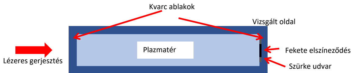
7-2. ábra: Meghibásodott rubídiumgőz cella vázlata
