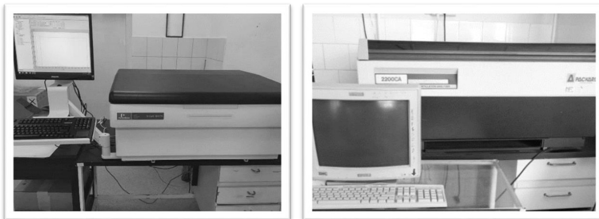
26. ábra: Balra látható a Tri Carb 4810TR (Perkin-Elmer) és jobbra a Tri Carb 2200 CA (Packard) folyadékszcintillációs mérőműszer
