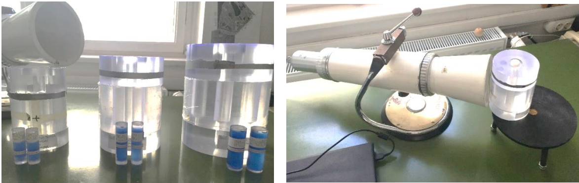
23. ábra: A SURO nyakfantom-sorozat három különböző (felnőtt, tinédzser és gyermek) méretű fantomjai, és a mérési elrendezés
